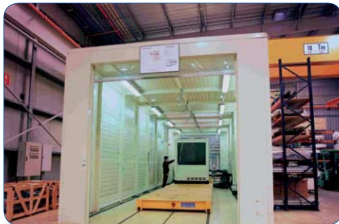
Все чиллеры проходят заводские испытания в ходе которых они проверяются путем имитации фактических условий эксплуатации.
