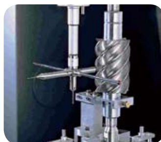
Оснастка «Medium 3D» для изготовления роторов винтовых компрессоров
