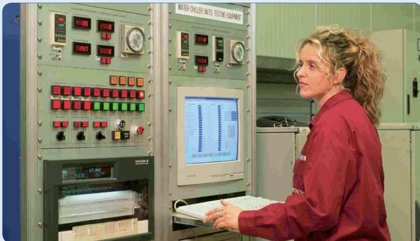
Компьютеризированная система учета результатов заводских испытаний получает в режиме реального времени все переменные параметры системы и проверяет правильность работы холодильной машины.
